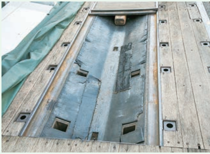
トレーラに施されたV字の溝がコイル材の安定を生む
