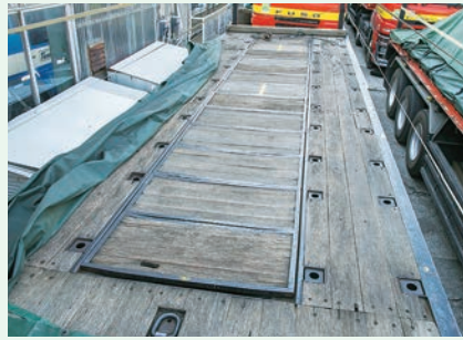
蓋をすれば、通常の平ボディシャーシとして使用できる
