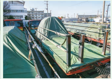
V字溝トレーラに積載され出発を待つ のみのコイル材。トレーラシャーシには 転落防止のガードも施されている
